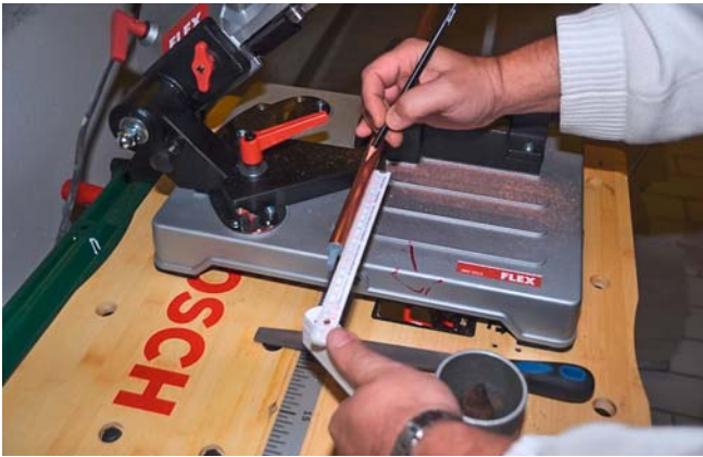
Schritt 1: Anzeichnen des Schnitts
