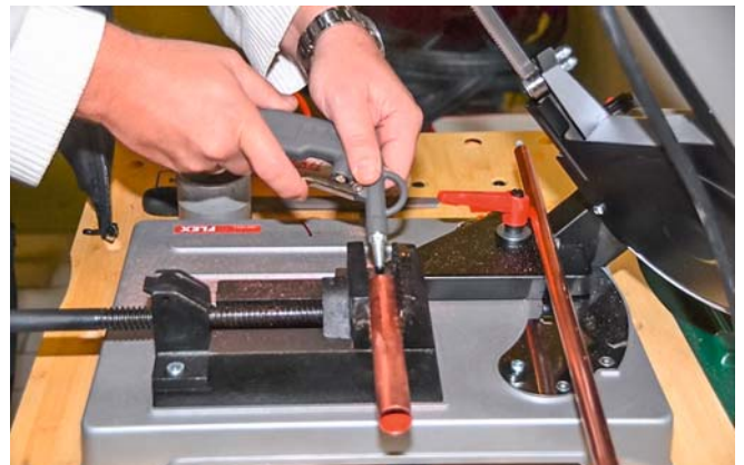
Schritt 6: Entfernung der Spanrückstände, beispielsweise wie hier, mittels Druckluft
