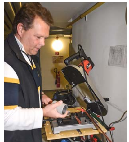
Schritt 2: Fachgerechtes Ablängen der Rohrleitung, hier mit einer Säge
