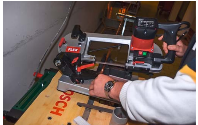
Schritt 2: Fachgerechtes Ablängen der Rohrleitung, hier mit einer Säge
