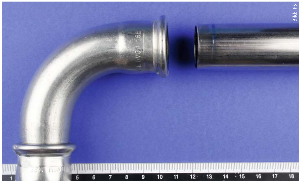
Bild 1: Dieser 90°-Einsteckbogen war schadenursächlich. Die Pressverbindung hat sich gelöst
