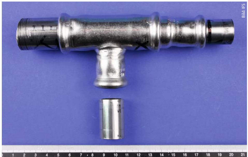
Bild 3: Die schadenursächliche Rohrleitungskomponente im zugesandten Zustand
