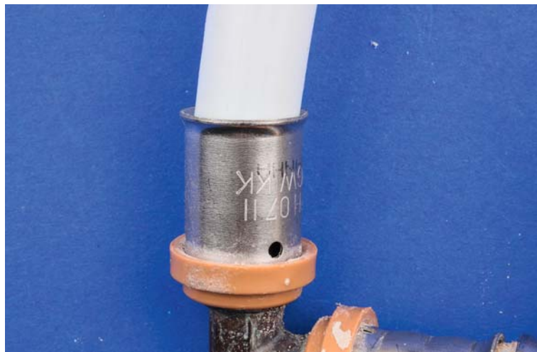
Auf dem Bild 3 ist die schadenursächliche Verbindung im ausgebauten Zustand im Labor zu sehen. Spuren einer Verpressung sind an der Presshülse des Fittings nicht vorhanden. Das Rohr lässt sich leicht aus der Muffe herausziehen
