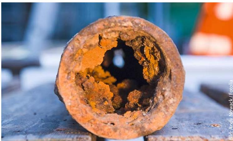
Reduzierter Heizrohrquerschnitt verursacht durch Steinbildung
