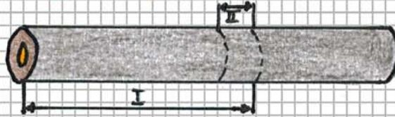
I Maß der Passlänge    II Maß für das abisolierte Rohrende
