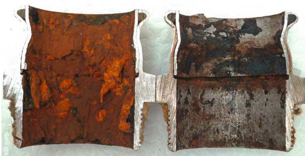
**Bild 1: Ein längsseits aufgeschnittenes Rohrstück, bei dem rechts die Deckschicht entfernt wurde, kann vergrößert in den Bildern 2 und als Beispiel für Lochfraßkorrosion betrachtet werden**
