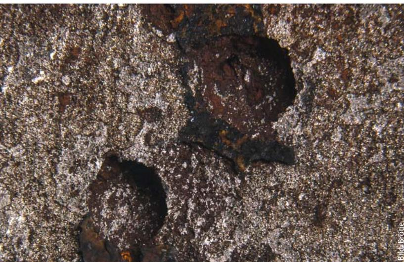
**Bild 3:** Eine weitere Vergrößerung des Bildes 2 zeigt eine klassische Lochfraßkorrosion
