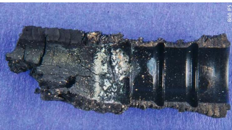
**Bild 3:** Deutlich ist auf der Innenseite des Schlauches Rissbildung durch Versprödung des Materials sichtbar
