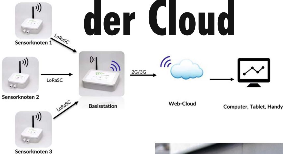
Das GoMess-System ist ein cloud-basiertes, kabelloses System für die Messung von U-Wert, R-Wert, Feuchtigkeit und Oberflächentemperatur. Mit dem Goms sind simultane Messungen mit bis zu 16 Sensorknoten möglich, die über die Cloud in Echtzeit überwacht werden können. Es ist nach Herstellerangaben das einzige System auf dem Markt, das quantitative Daten zu der Dämmqualität von Gebäudeelementen liefert.
