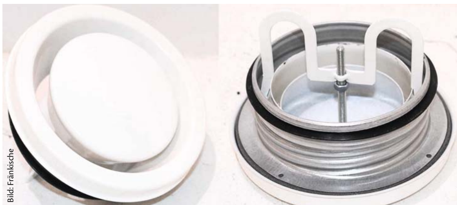
Ein Tellerventil von Fränkische: links die Ansicht zum Raum, rechts die Ansicht zum Luftkanal mit Blick auf die Einstellmöglichkeit
