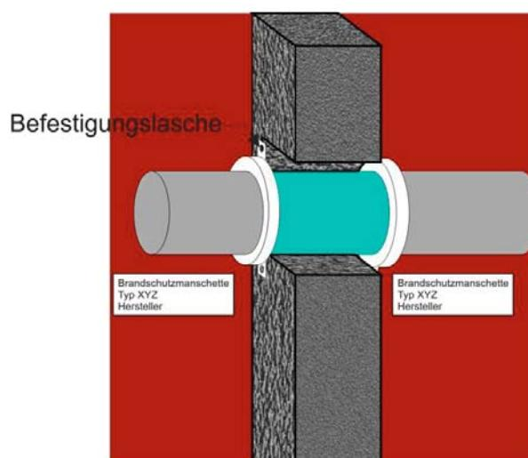
Bei einer Wanddurchführung muss an beiden Seiten eine Branschutzmanschette montiert werden.
