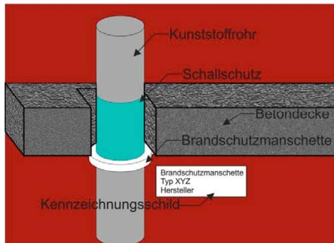
Bei einer Deckendurchführung ist eine Branschutzmanschette in der Regel ausreichend.
