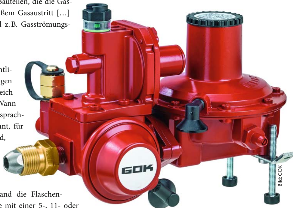
UPS0 = Under Pressure Shut Off, zu Deutsch: Unterdruck-Sicherheitsabsperreinrichtung. Dabei handelt es sich um eine Sicherheitseinrichtung in Druckreglern für Gastanks, die bei Druckabfall in der nachfolgenden Leitung, zum Beispiel durch Beschädigung oder Bruch der Rohrleitung, den Gasdurchfluss sperrt
