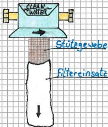
4. Neuen Filtereinsatz auf das Stützgewebe schieben. Den Einsatz dabei nicht mit den Fingern berühren, sondern durch die Tüte festhalten. Tassendichtung kontrollieren und Filtertasse aufschrauben.
