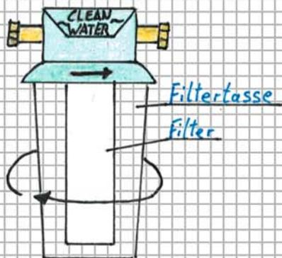
3. Filtereinsatz vom Stützgewebe ziehen und Filtertasse reinigen.
