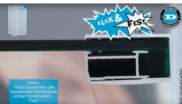
**3.) Mit dem Klemmprofil wird das Glas in der richtigen Position befestigt – ganz ohne Schrauben. Ein „Klick“ signalisiert das erfolgreiche Einrasten der Leiste**
