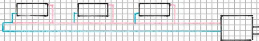
**Tichelmann-System:** Beim Tichelmann-System werden die Heizkörper über Vor- und Rücklauf mit dem Kessel verbunden. Das Besondere ist, dass der Heizkörper mit dem kürzesten Vorlauf den längsten Rücklauf hat.
