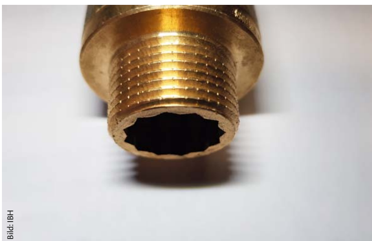
Ein industriell gefertigtes Gewinde, hier in ¾ Zoll, ist oft schon aufgeraut und bietet daher Hanf oder Teflon den nötigen Halt
