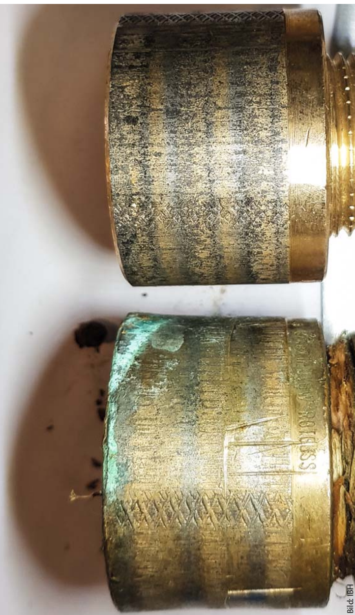
Schadensbild 1: Oben eine fabrikneue Hahnverlängerung, unten eine solche mit minimaler Überdehnung. Die Überdehnung führte zur Korrosion an einem Trinkwasseranschluss
