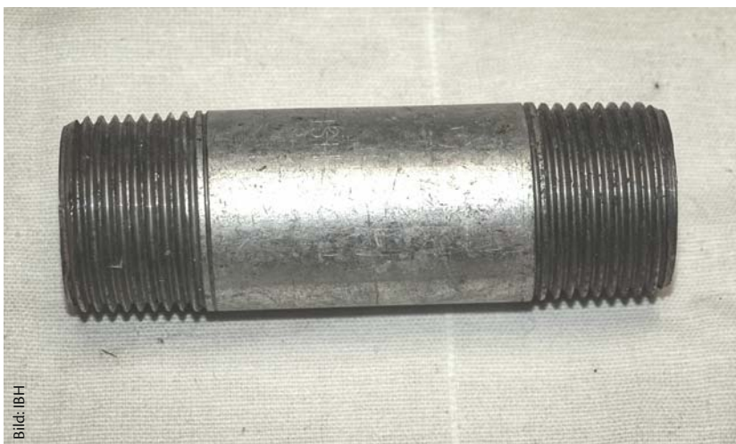
Ein Rohrnippel aus der Gewindeschneidemaschine besitzt herstellungsbedingt sehr glatte Hügel und Täler. Da kann sich kein Hanf oder Teflon-Band halten.
