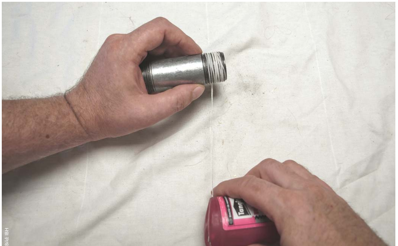
Zwölf Wicklungen um diesen zölligen Nippel reichen nach Herstellerangaben aus, um eine Dichtheit herzustellen
