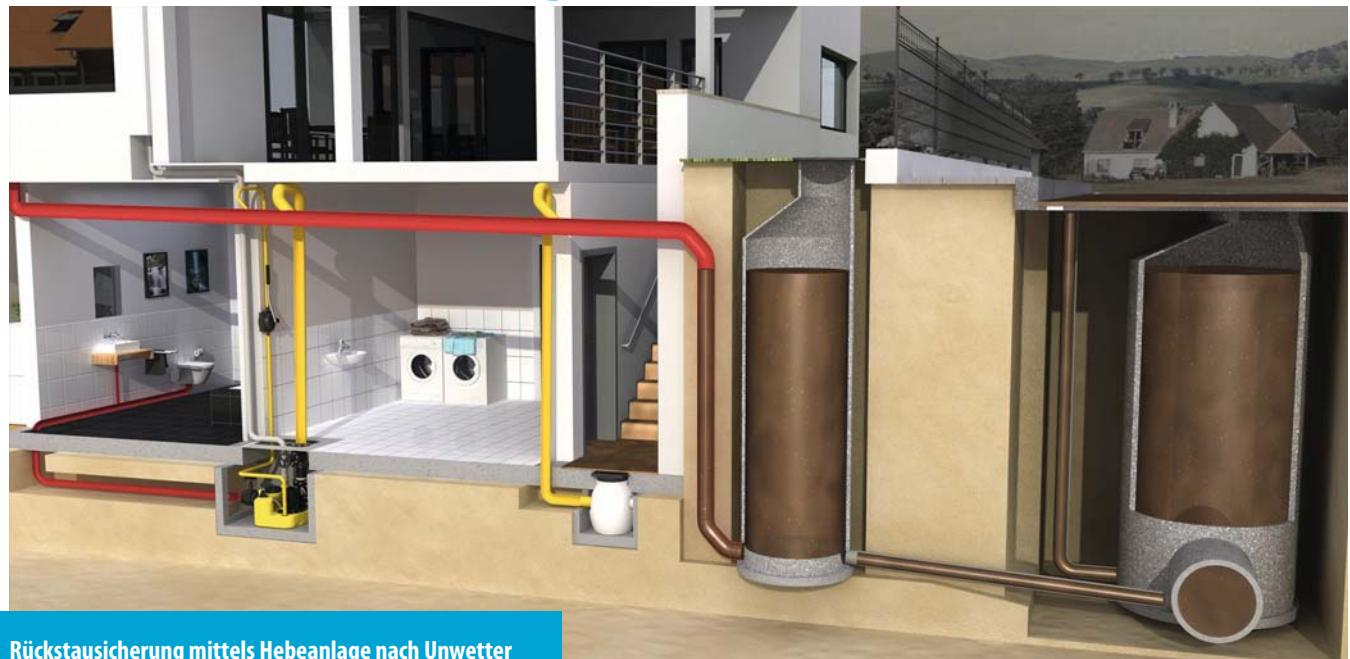
Rückstausicherung mittels Hebeanlage nach Unwetter und Rückstau aus dem Kanal
