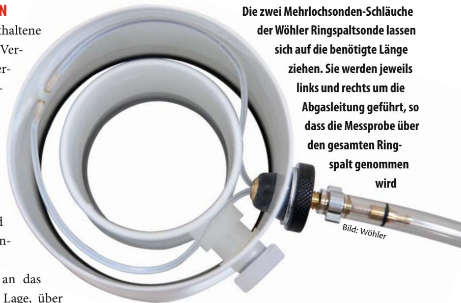
Die zwei Mehrlochsonden-Schläuche der Wöhler Ringspaltsonde lassen sich auf die benötigte Länge ziehen. Sie werden jeweils links und rechts um die Abgasleitung geführt, so dass die Messprobe über den gesamten Ringspalt genommen wird
