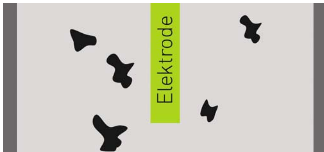
Funktion des elektrostatischen Feinstaubabscheiders 1.) Feinstaubpartikel strömen mit der Abluft durch den Abgaskanal.
