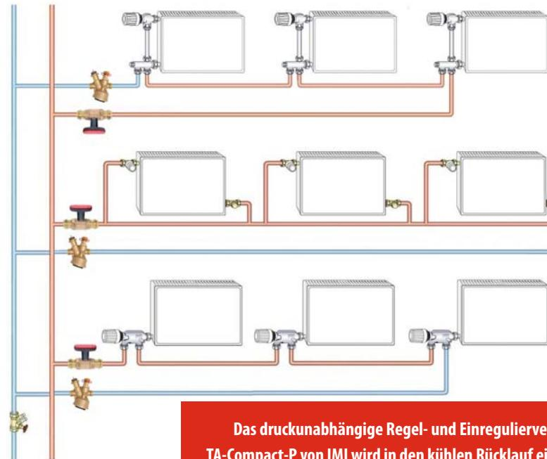
**Das druckunabhängige Regel- und Einregulierventil TA-Compact-P von IMI wird in den kühlen Rücklauf einer Einrohrheizung nachgerüstet**
