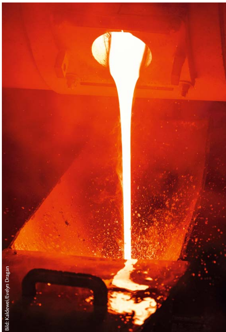
Abstich in der Kaldewei-Emailschmelze: Dabei wird eine glühend heiße Glasschmelze in kaltem Wasser abgeschreckt
