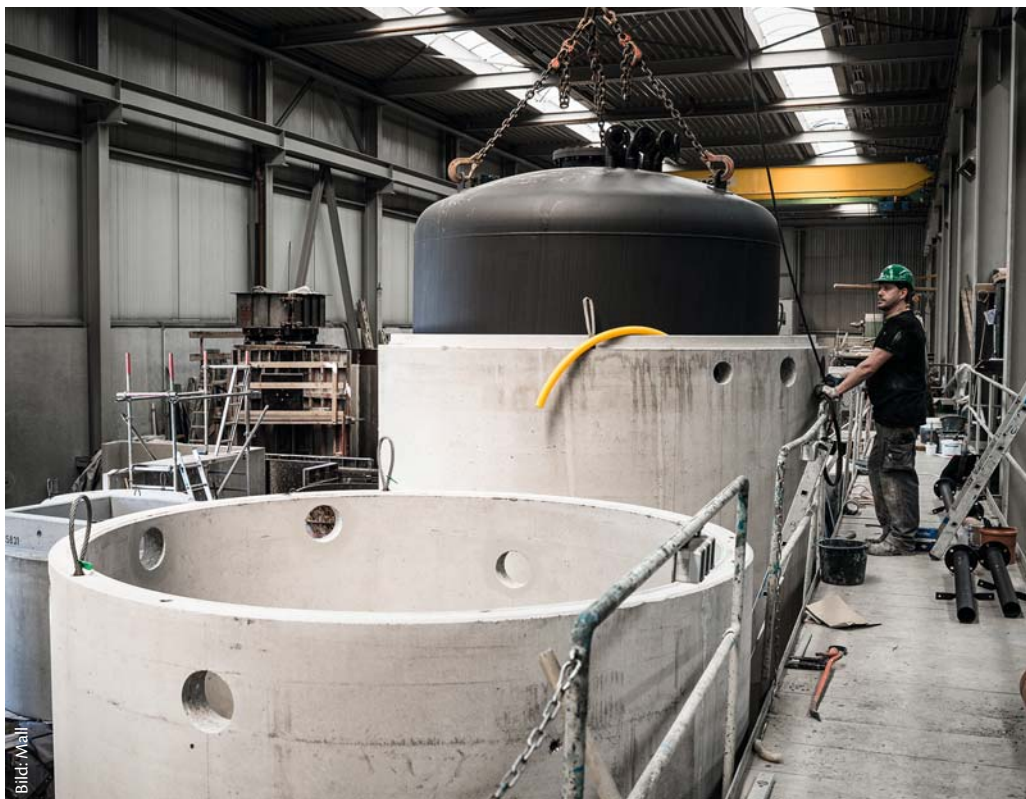
Produktion der Stahlbeton-Pufferspeicher ThermoSol: Innenbehälter aus Stahl, schwarz grundiert, mit verschraubtem Revisionsflansch
