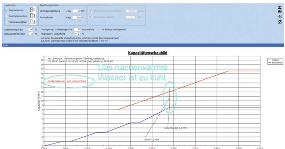
Bild 3: In diesem Kapazitätsschaubild wird der Anforderung an Warmwasser die Kesselleistung von 20 kW gegenübergestellt. Die Leistung reicht nicht aus, weil die Temperatur des nach erwärmten Wassers im gewählten Speichersystem zu gering ist, also unter die geforderte Temperatur von 45 °C absinkt
