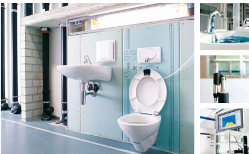
Lebensecht – Abwasserturm und Akustiklabor im GIZ Pfullendorf
