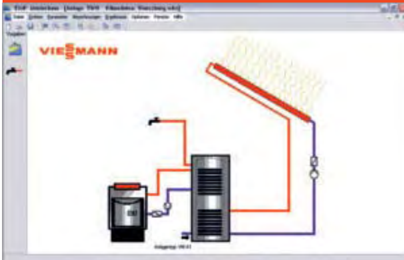
Abb. C.4-2 ESOP: Solaranlage zur Warmwasserbereitung
