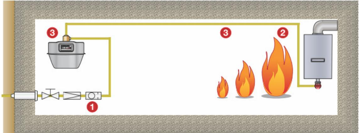
Im Brandfall soll der Gasströmungswächter (1) die Gaszufuhr absperren. Dies geschieht nur, wenn der Schließvolumenstrom überschritten wird. Damit dies geschehen kann muss das Kunststoffrohr so versagen, dass eine ausreichend große Leckageöffnung („vorleckfreier Bruch“) entsteht (2). Weiterhin muss die verbleibende Rohrleitung (3) noch soweit intakt sein, dass der Schließvolumenstrom auch tatsächlich transportiert werden kann.
