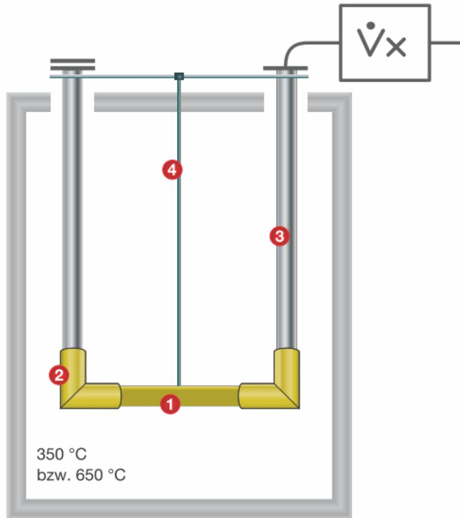
Ein ca. 30cm langes PE-X Rohrstück (1) und zwei ca. 1m lange Stahlrohre (3) werden mit zwei 90°-Übergangsverbindern mit einseitigem Muffengewinde (2) zu einem U-förmigen Bauteil verbunden. Dieses Bauteil wird in den Prüfofen eingebracht. Das 30 cm lange PE-X Rohrstück (1) wird zusätzlich „eigengewichtsentlastet“. In der Norm wird dafür z. B. ein Aufhängedraht (4) vorgeschlagen. Andere Arten der „Eigengewichtsentlastung“ sind auch zulässig.
