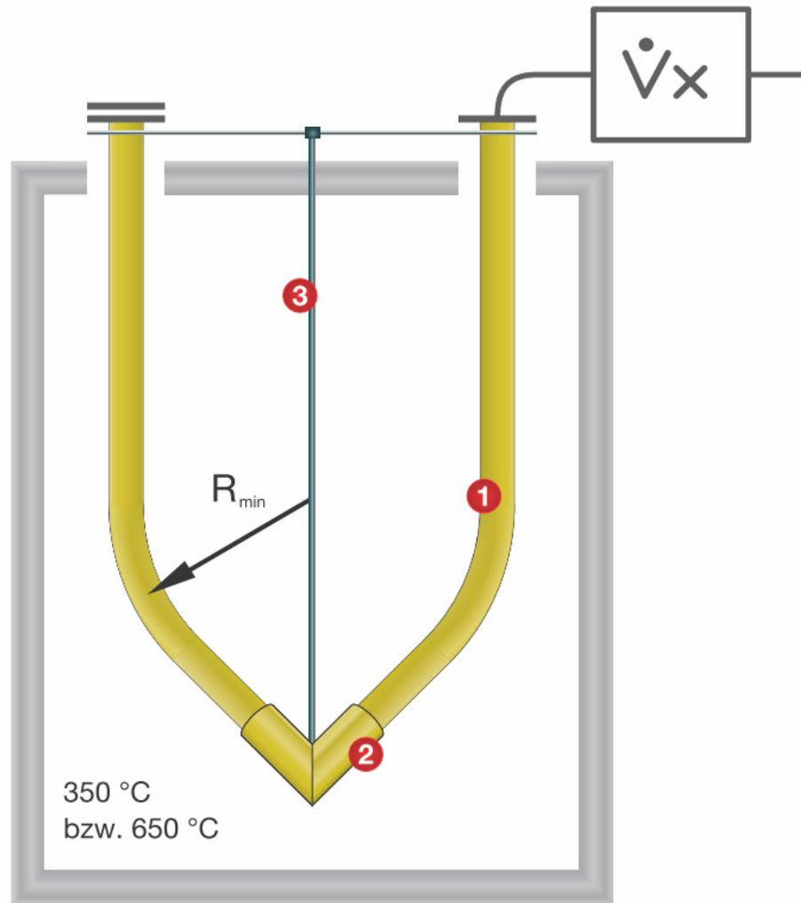
Zwei ca. 1 Meter lange Verbundrohre (1) werden mit einem 90°-Winkelverbinder (2) verbunden und anschließend bei kleinstem zulässigen Biegeradius ( $R_{min}$ ) zu einem U-förmigen Probekörper gebogen. Dieses Bauteil wird in den Prüfofen eingebracht. Der 90°-Winkelverbinder wird zusätzlich „eigengewichtsentlastet“. In der Norm wird dafür z. B. ein Aufhänger (3) vorgeschlagen. Andere Arten der „Eigengewichtsentlastung“ sind auch zulässig.
