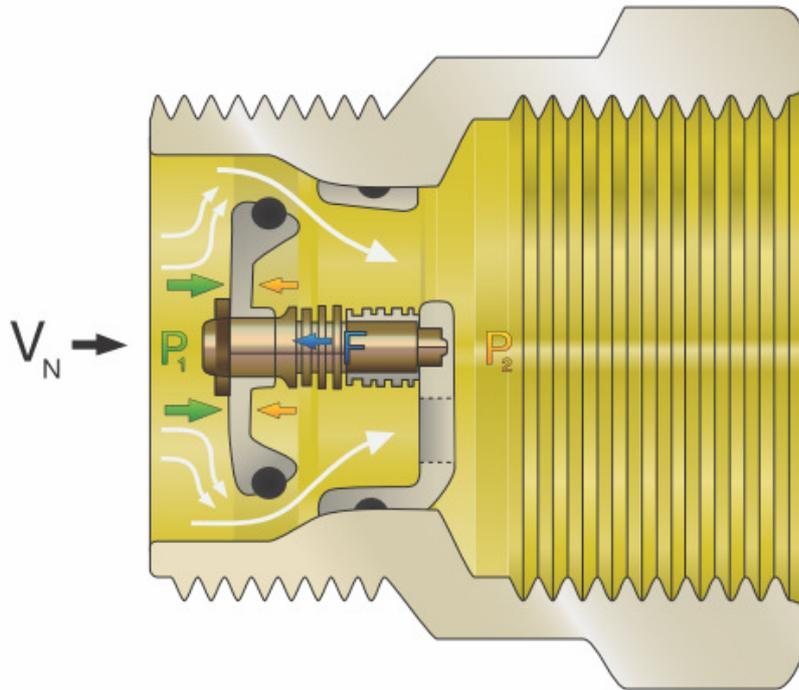
Die Federkraft (F) und die Kraft des Hinterdrucks (P<sub>2</sub>) hält den Ventilteller des Gasströmungswächters bei üblichem Betrieb offen. Übersteigt der Volumenstrom (V<sub>N</sub>) einen bestimmten Wert (Schließvolumenstrom), so drückt der dynamische Druck (P<sub>1</sub>) den Ventilteller auf den Ventilsitz und stoppt die Gaszufuhr.
