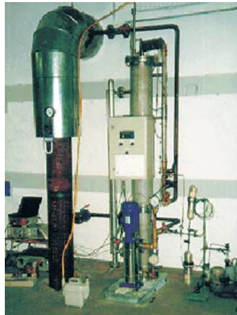
Bild 2: Stickstoffreduzierung durch 'servitec' Teilstromentgasung in einer Versuchsanlage der Energieversorgung Halle
