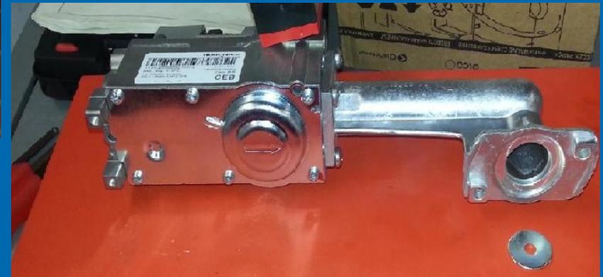
Zuerst wird die Gasarmatur auf den Brenner montiert
