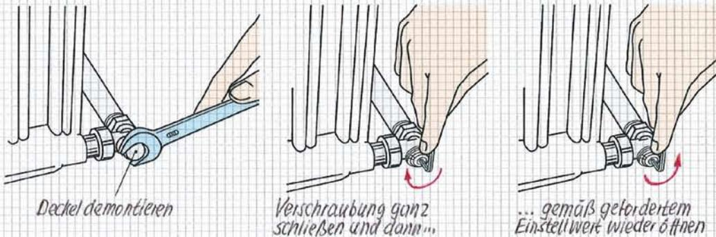
Durch den **hydraulischen Abgleich** sind die **Druckverhältnisse** und die **Volumenströme** in einer Heizungsanlage so zu regulieren, dass jeder Heizkörper ausreichend mit warmen Heizungswasser versorgt wird.
