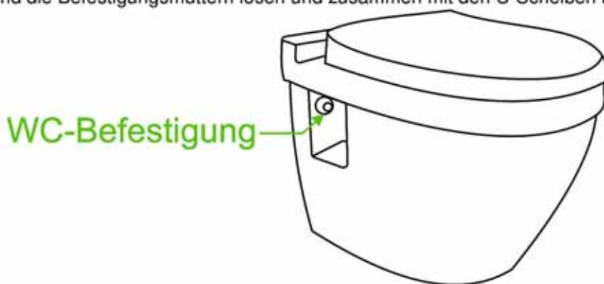
WC vorsichtig und gerade von den Anschlussrohren ziehen, Siphoninhalt in den Eimer schütten und WC auf dem Handtuch ablegen. Silikonreste an Wand und WC entfernen. Lippendichtung am Abfluss und den Spülrohrverbinder auswechseln und mit reichlich Schmierseife benetzen.
