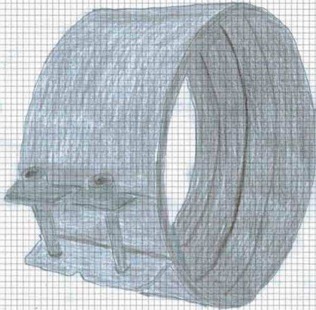
Herstellen einer Rohrverbindung mittels CV-Verbinders:
