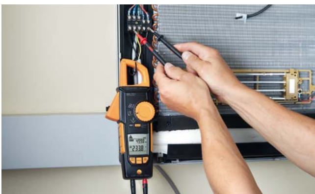
Spannungsmessung an einem Klimagerät mit testo 770 .
