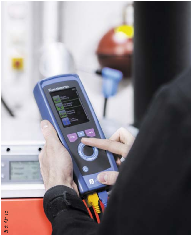
Moderne Messgeräte reduzieren den Aufwand auf die Einhaltung der Messvorgaben wie die Suche nach dem Kernstrom. Gerechnet und angezeigt wird kontinuierlich
