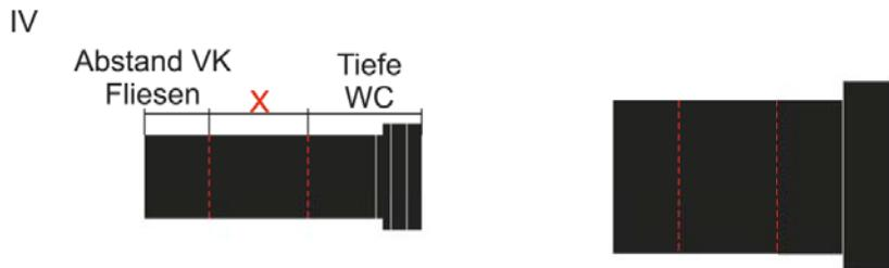
Beide Anschlussrohre um das Maß X kürzen und entgraten
