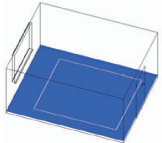
Horizontale Ebene (0,1 m über Fußboden)
